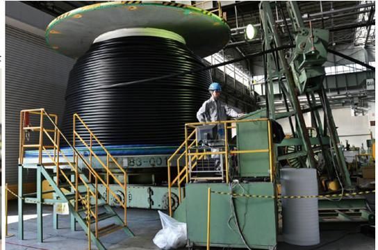
ボビン状の大型装置に巻き取られる海底ケーブル
