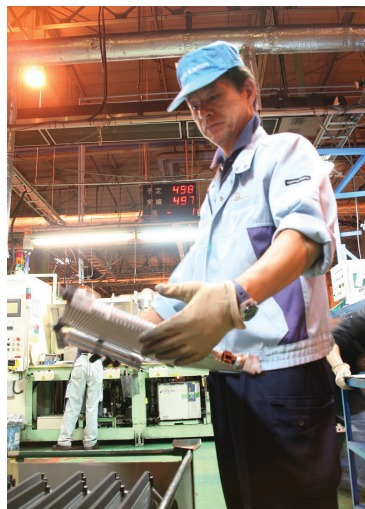
アルミコンデンサーの最終の製品チェックをする熟練工
